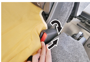
④シートベルトキャッチ付近の面ファスナー同士を貼り合わせます。
