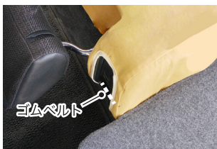
⑤足元側シートスライドレバー下部にゴムベルトを引っ掛けます。
