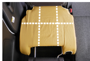
⑥手順2でシート下へ降ろした面ファスナーは足元側で対面する面ファスナーと貼り合わせ、両側面の面ファスナー同士を貼り合わせます。
