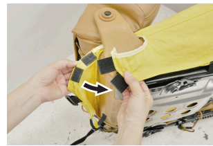
⑨ カバー側面下部後方(センターコンソール側)の面ファスナー2箇所を手順②で押し込んだ部分の端の面ファスナーと貼り合わせます。
