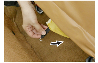
⑤ 手順②で押し込んだ部分の中央付近に取付けられているフックをシート下の金具部分に引っ掛けて固定します。
