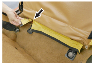
③ 押し込んだ部分は背裏側から引っ張り出します。このとき、画像で示した箇所の配線を避けてください。
