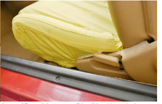
⑦ 貼り合わせたベルトはリクライニングレバー下部のパネルの下側へ押し込みます。
