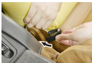
⑧ カバー表側下部（センターコンソール側）の面ファスナーをヒンジの下側を通して背裏側へ回し、対面する面ファスナーと貼り合わせます。
