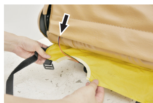
③ 押し込んだ部分は背裏側から引っ張り出します。このとき、画像で示した箇所の配線を避けてください。
