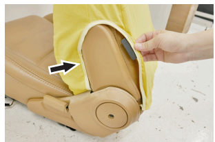
④ リクライニングレバー側のパネルの隙間にPP板を2箇所差し込みます。
