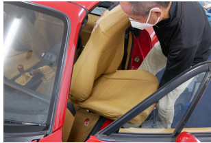
⑤ 内装やボディを傷つけないよう注意しながらシートを車外へ出します。ソフトトップの場合はオープンにしておく簡単に作業できます。
