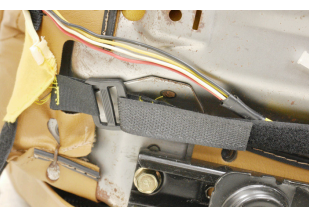
④ 足元側下部の面ファスナー付ベルト2箇所は、シート下から手順②で押し込んだ部分に取付けられている対面するアジャスターへ通し、折り返して面ファスナーを貼り合わせます。
