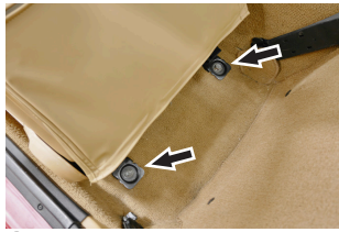
② シートを前方にスライドさせ、後側の六角ボルト2箇所を外します。
