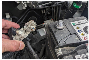
① バッテリーのマイナス端子を外します。
