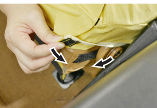
⑧ カバー表側下部（センターコンソール側）の面ファスナーをヒンジの下側を通して背裏側へ回し、対面する面ファスナーと貼り合わせます。
