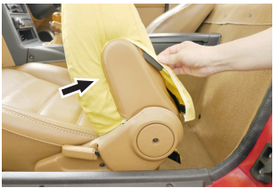
④ リクライニングレバー側のパネルの隙間にPP板を2箇所差し込みます。
