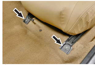
③ シートを後方にスライドさせ、前側の六角ボルト2箇所を外します。
