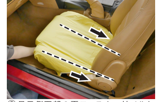
③ 足元側下部の面ファスナー付ベルト2箇所をシート下から背裏側へ通します。
