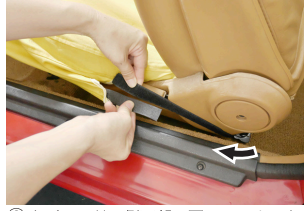
⑥ カバーのドア側下部の面ファスナーを手順②で押し込んだ部分の端に取付けられているベルトと貼り合わせます。
