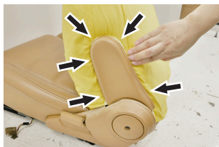
⑤ パネルの隙間へカバー端を押し込みます。
