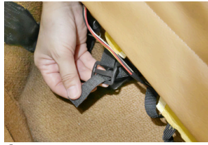
④ カバー足元側の面ファスナー付ベルトは、右図を参考に手順②で押し込んだ部分に取付けられているアジャスターへ通し、折り返して面ファスナーを貼り合わせます。
