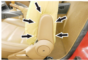
⑤ パネルの隙間へカバー端を押し込みます。
