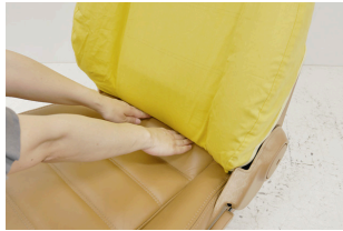
② シートの背と座の間にカバー下部をしっかりと押し込みます。
