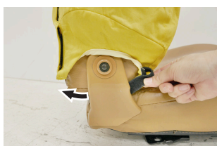
⑧ カバー表側下部(センターコンソール側)の面ファスナーをヒンジの下側を通して背裏側へ回し、対面する面ファスナーと貼り合わせます。
