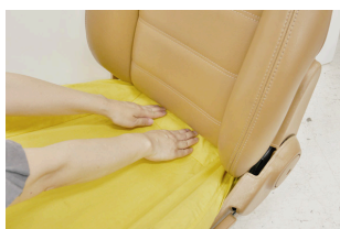
② シートの背と座の間にカバーをしっかりと押し込みます。
