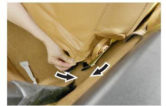
⑩ カバー側面下部後方（センターコンソール側）の面ファスナー2箇所を手順②で押し込んだ部分の端の面ファスナーと貼り合わせます。
