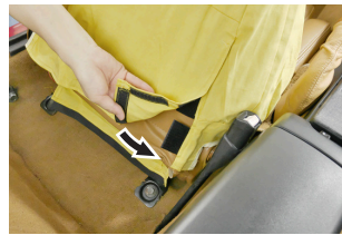
⑥ 背裏側下部（センターコンソール側）の面ファスナー同士を貼り合わせます。
