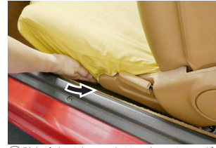
⑦ 貼り合わせたベルトはリクライニングレバー下部のパネルの下側へ押し込みます。
