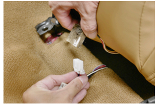
④ シートのマクラ部分にスピーカーが埋め込まれている場合は、フロアから接続されている配線のコネクターを外します。
