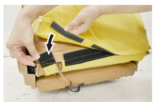
⑦ 背裏側下部の面ファスナーを手順③で引っ張り出した部分の面ファスナーと貼り合わせます。
