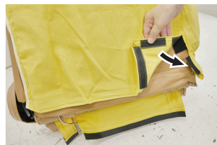
⑥ 背裏側下部(センターコンソール側)の面ファスナー同士を貼り合わせます。
