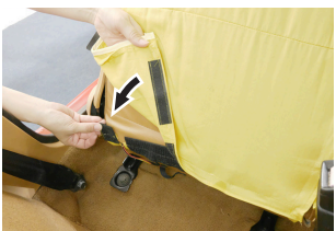
⑦ 背裏側下部の面ファスナーを手順③で引っ張り出した部分の面ファスナーと貼り合わせます。
