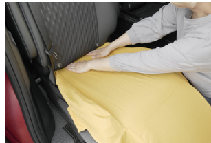
② シートの背と座の間にストッパーをしっかりと押し込みます。
