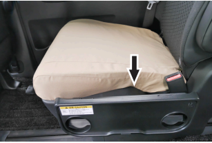
④ 両サイドのストッパーをシート本体と樹脂パネルの間へしっかりと押し込みます。
