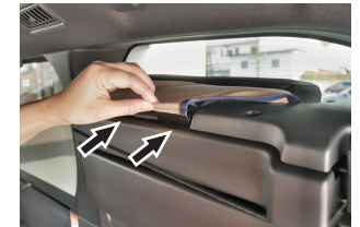
⑥ カバー側面のPP板2箇所を画像のようにパネルの間へ差し込みます。
