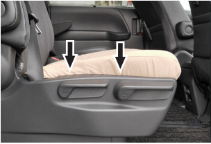
④ 両サイドのストッパーをシート本体と樹脂パネルの間へしっかりと押し込みます。
