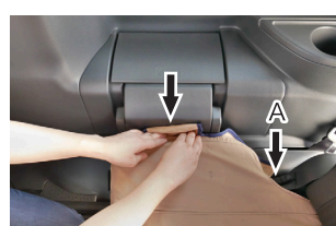
③ 窓側に取付けられているストッパーをパネルの間へしっかりと押し込みます。このときA部分のPP板、面ファスナーをシート下へ回しておきます。
