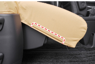
⑥ オットマンの裏側のシート表皮と内側の成形パネルのスキマにPP板をしっかりと差し込みます。反対側も同様です。
