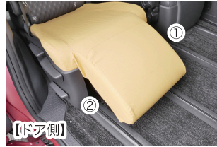
⑤ オットマンの側面下部はPP板を使用して固定します。手順⑥を参考に、ドアの反対側から取付けてください。
